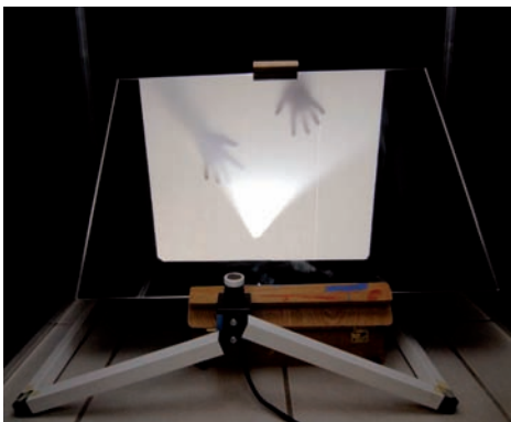
(c) Aufnahme aus Richtung des Beamers mit IR-Kamera im Vordergrund und sichpiegelnder Projektionsfläche
